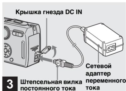
→ Откройте крышку гнезда DC IN и подсоедините адаптер переменного тока (прилагается) к гнезду DC IN Вашего фотоаппарата.
