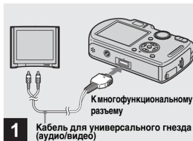
→ Подсоедините прилагаемый кабель для универсального гнезда (аудио/видео) к многофункциональному разъему фотоаппарата и к входным аудио/видео гнездам телевизора.
