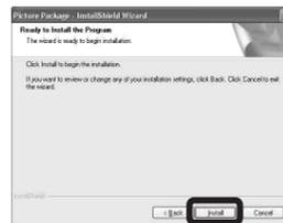
Если после установки программного обеспечения появится экран “Welcome to setup for Direct X” (добро пожаловать в программу установки Direct X), следуйте инструкциям на экране.
