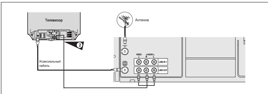
Вы можете подключить видеоманитфон к телевизору с помощью RCA кабеля, если на телевизоре имеется соответствующий вход. Это даст вам:
