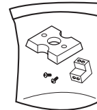
Montier-adapter Schrauben(2) Anschlussklemme Block
