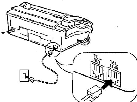
Соедините один конец провода с гнездом, расположенным на задней стенке аппарата и обозначенным "TEL. LINE". Другой конец провода подключите к стандартной индивидуальной телефонной розетке.
