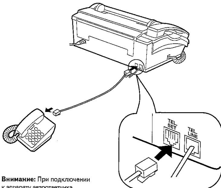
**Внимание:** При подключении к аппарату автоответчика убедитесь в том, что линия подключена к гнезду **телефонной линии** автоответчика, а не к гнезду телефона.
