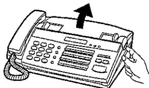
Захватите рычажок, находящийся на корпусе факса справа от крышки секции бумажного рулона, сдвиньте его вверх и откройте крышку секции.
