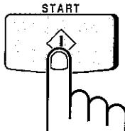
Услышав звуковой сигнал факса о готовности к приему факсимильного сообщения, нажмите на кнопку **START**. Опустите телефонную трубку, если Вы использовали ее при наборе номера.
