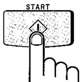
Нажмите на кнопку **START**. После соединения передача документа начнется автоматически.
