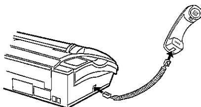
Соедините шнур телефонной трубки с трубкой и аппаратом в соответствии с рисунком.
