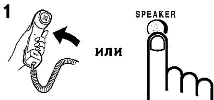
Поднимите трубку или нажмите на кнопку **SPEAKER**. Вы услышите сигнал незанятой линии.
