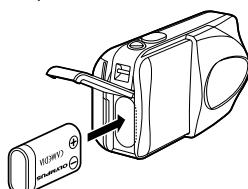
При использовании блока литиевых батареек CR-V3 установите его в ориентации, показанной на иллюстрации.
