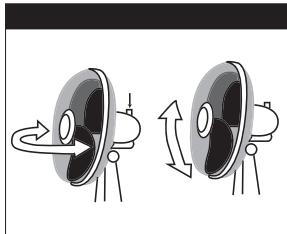
Присоедините переднюю решетку. Обе решетки должны быть плотно соединены. Закройте предохранитель на передней решетке.
