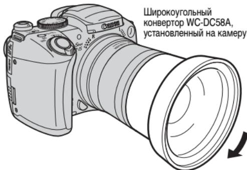
Широкоугольный конвертор WC-DC58A, установленный на камеру.
