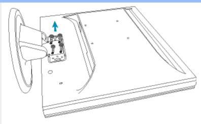
2) Quite los 4 tornillos y retire la base del monitor LCD.
