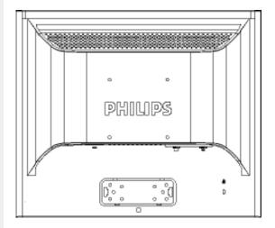
Observación: Este monitor admite sistemas de montaje VESA de 100 x 100 mm.
