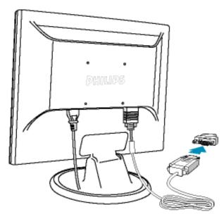
Observación: Si el equipo es Apple Macintosh, deberá conectar el adaptador especial para Mac a un extremo del cable de señal del monitor
