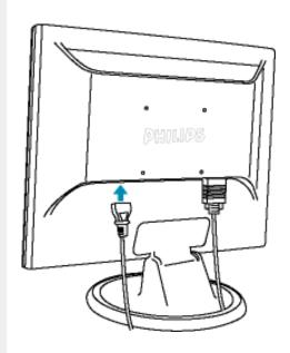
1) Conecte los cables a los conectores
