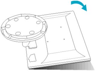
1) Den Monitor mit der Vorderseite nach unten auf eine stabile Unterlage legen.
