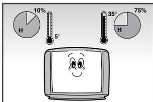
Udsæt IKKE TV-apparatet for ekstreme temperaturforhold (under 5°C og over 35°C) eller for ekstrem fugtighed (mindre end 10% og mere end 75%).
