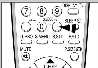
La touche "S.MODE I-II" affiche/contrôle le processus de sortie du signal audio. Lorsque vous allumez votre téléviseur, le mode est automatiquement réglé soit sur "Dual-I", soit sur "STEREO", selon l'émission diffusée.
